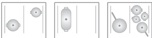
Nella zona a induzione dei piani misti il **sistema Multizone**, permette di utilizzare nello stesso momento pi  recipienti di differenti dimensioni, offrendo una **grande flessibilit  di posizionamento** e rendendo il **piano ancora pi  efficiente**.
